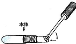
スティックを斜め上より本体に差し込みパチンと音がするまで押し込む
